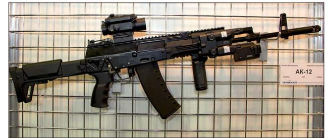
нитель, переключатель вида огня, защёлка магазина, останов затвора) стали доступны для манипуляции одной рукой, удерживающей оружие. Автомат имеет три режима огня: одиночными, с отсечкой в 3 выстрела и автоматический. Боепитание может производиться из различных магазинов: коробчатых, рассчитанных на 30 или 60 патронов, или дискового, вмещающего 95 боеприпасов.
